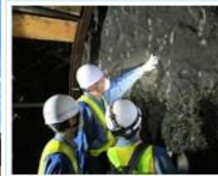
▲ボーリング・試掘坑による地質・断層調査
