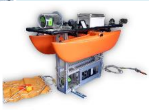
▼水中点検ロボット
